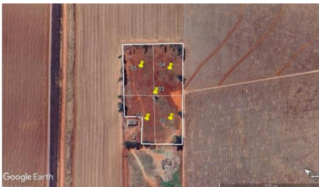
Figura 01 – Demonstra os pontos de realização das sondagens com suas respectivas coordenadas geográficas. Ponto 01 - 811581.00 m E / 7992056.00 m S, Ponto 02 - 811624.00 m E / 7992003.00 m S, Ponto 03 - 811656.00 m E / 7992083.00 m S, Ponto 04 - 811737.00 m E / 7992094.00 m S, Ponto 05 - 811690.00 m E / 7992163.00 m S.
